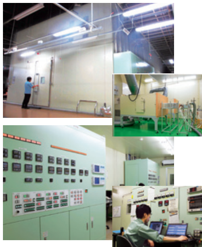
写真上：国内最大級の最大50馬力の熱量計測室。6機種同時に様々な条件のもとで測定が可能。 写真下：大量の測定データを分析する集中制御室
