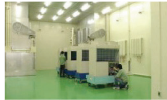
恆溫、恆濕實驗室 在各種溫度和濕度條件下，確認產品冷氣及暖氣產品性能。
