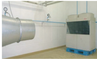
室外機測試室 測試即使在下雨或颱風的惡劣環境下，室外機依然能穩定運作。
