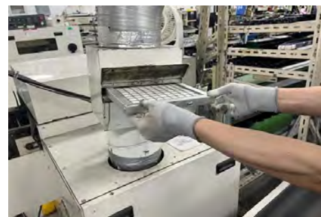
フィルター交換作業の様子
