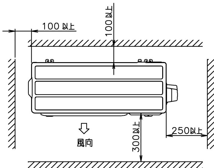
\* 効率の良い運転のために、正面・背面・右側面・左側面のうち2方向を開放してください。
