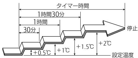
おやすみタイマーを設定すると、30分ごとに設定温度が1°Cずつ下がります。合計4°C下がった時点で、その温度を保ち、設定した時間後に自動的に運転を停止します。
