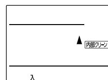
▶ 内部クリーンを設定すると、リモコン表示部に [内部クリーン] が表示されます。
