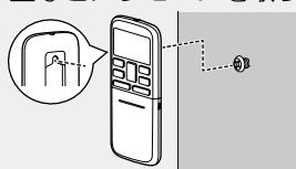
リモコン取付け用ネジを柱や壁に取り付け、リモコン背面のへこみに取り付ける
