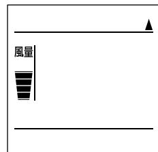
リモコン表示部に、設定した風量が表示されます。
