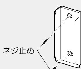
付属のネジ2本で、リモコンホルダーを固定する。
