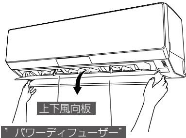
※ 無理に強い力を加えると、上下風向板・"パワーディフューザー"が破損したり内部の部品が故障したりするおそれがあります。
