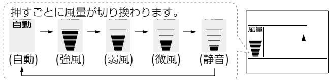
リモコン表示部に、設定した風量が表示されます。
