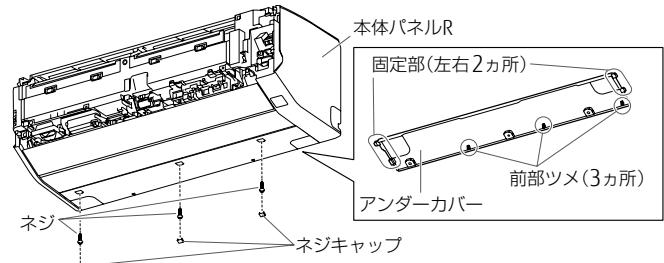
④アンダーカバーの固定部(左右2カ所)、前部ツメ(3カ所)取り付けます。
