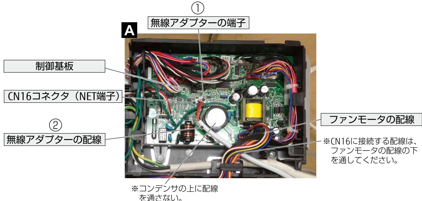
③ネジを外し、CN16 に接続した配線を電源ケーブルの奥に入れて、機外に引き出します。
