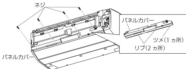
③ネジキャップをはずし、アンダーカバーのネジ(3カ所)をはずします。
