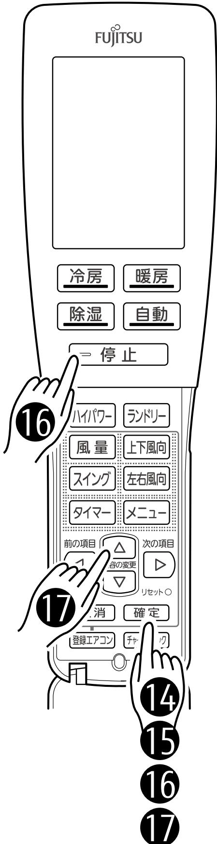
15 確定 を押して、画面上部に「登録してください」を表示させる
