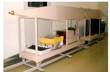
仕様：10～1GHzの反射：S11/ S22、透過：S21 測定
