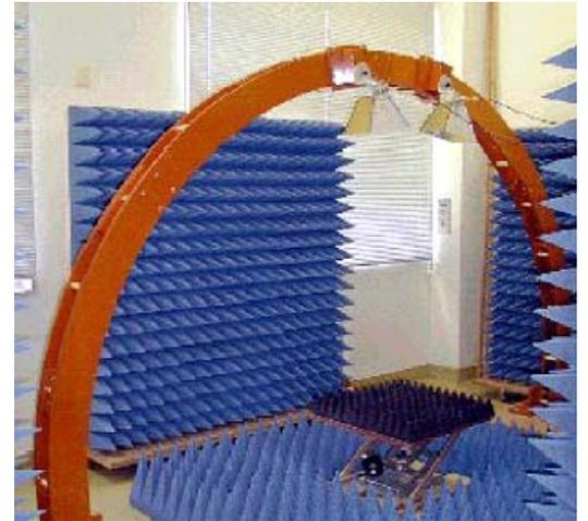
仕様：1G～40GHzの反射減衰量測定、角度設定：0～90°
