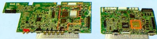
従来の信号処理基板(左)とAVMを使った新しい基板(右)。オレンジ色で囲まれた部分がAVMに統合されたことになる
