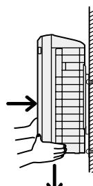
※必要に応じて、設置場所材質に適合したアンカーを使い、脱落することのないように取り付けてください。
