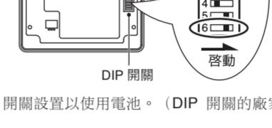
更改 DIP 開關設置使用電池。(DIP 開關的廠家設置是不使用電池。)
